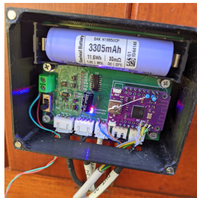
Obrázek 2: Sběrný modul měření bez magnetického krytu (12/04/2025).
