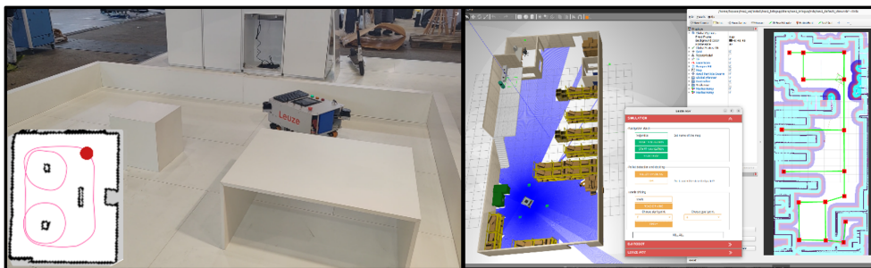
Obrázek 2: a) TinyAGV a virtuální dráha , b) Simulace a ovládací prostředí RViz
